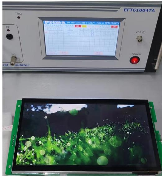
图 4-4 群脉冲测试图
